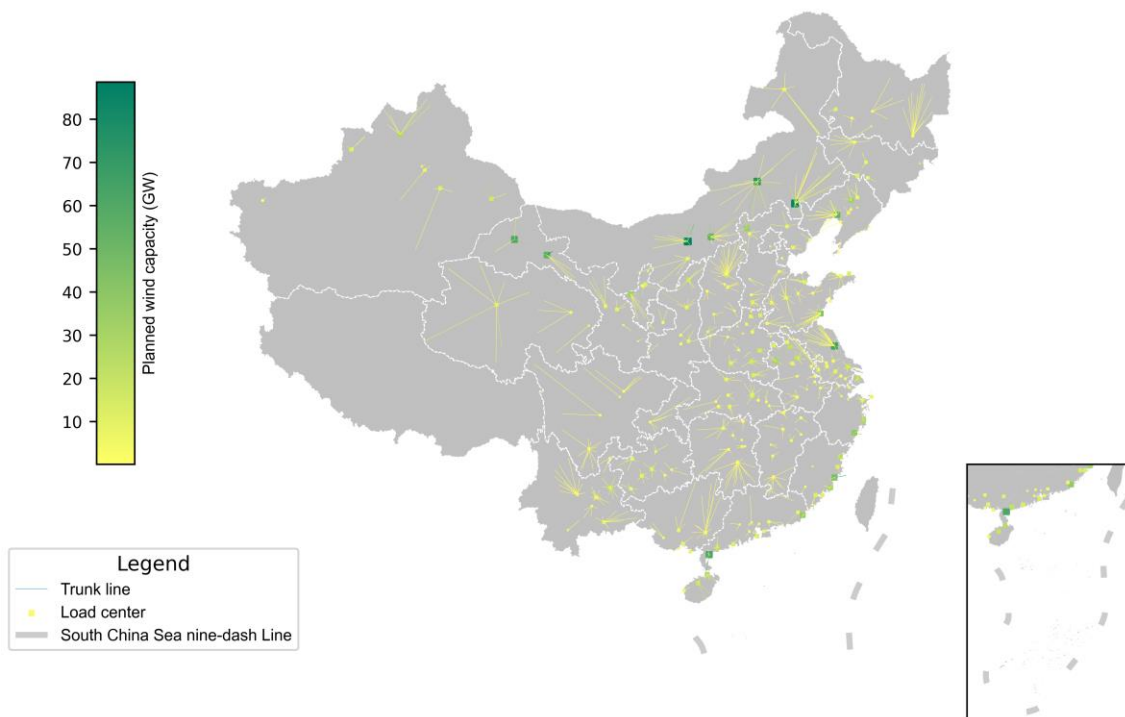
Fig. 风力 (A) 和光伏 (B) 发电的主干网容量增强 (GW) 。 由于西部资源集中且负荷中心较少，单负荷中心的主干网增强容量显著高于东部
